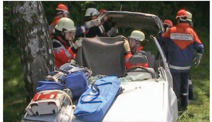
Das Dach des verunfallten Fahrzeuges wird entfernt.
