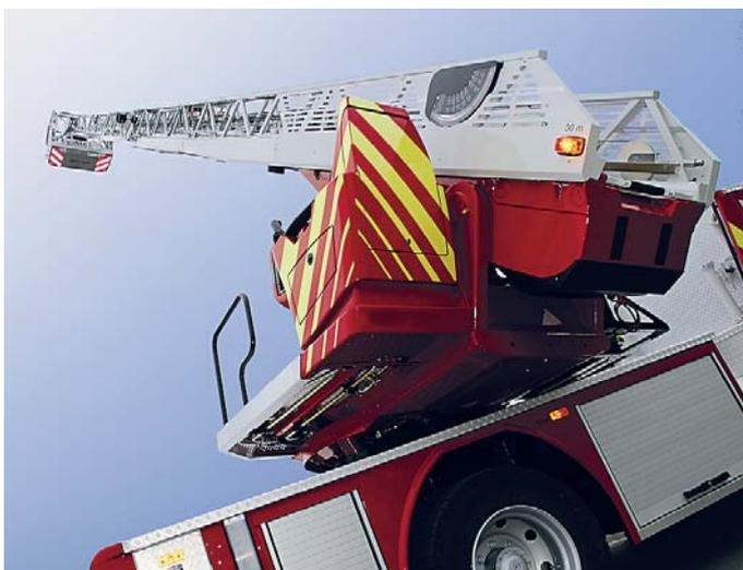
Zwei Schrägscheibenkugelkränze zusammen mit hydraulischen Stellmotoren von Rexroth gleichen Neigungen bis zu 8,5 Grad aus.
